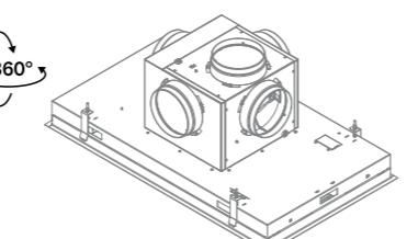
Cubic motor lze také odmontovat a umístit jinde v budově. Kabel o délce 4 cm (součást dodávky) propojuje stropní odsavač s motorem. V případě potřeby lze tento kabel prodloužit pomocí prodlužovacího kabelu o délce 5 m (k objednání samostatně).
