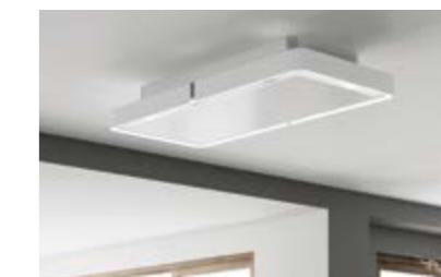
Výparы z vaření nestoupají přímo nahorу, ale pod úhlem 10° až 15°. Pro efektivní provoz je důležité, aby celá konstrukce, ve které nainstalovaný stropní odsavač, měla alespoň stejnou šířku a hloubku jako varná deska. Vytvořte přesah přibližně 30 cm kolem stropního odsavače, abyste zabránili úniku výparů. Okraje o výšce 5 až 10 cm navíc zajistí, že unikne méně par.
